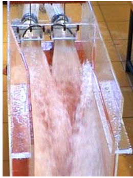
Hydraulic Structure Souš, Černá Desná River M_I = 12,5
